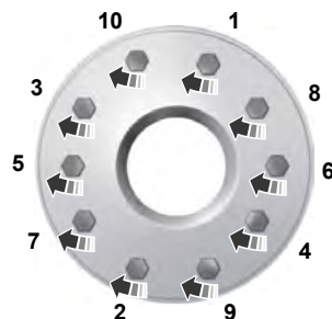
10-lug nut torque sequence
