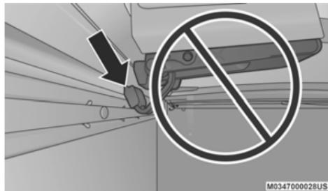
**Improper Clamp Position**
