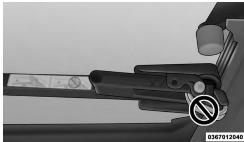
**Improper Clamp Position**
